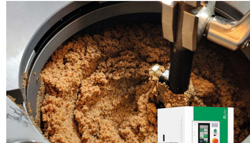
DLyte Polierprozess in einer Desktop Pro
