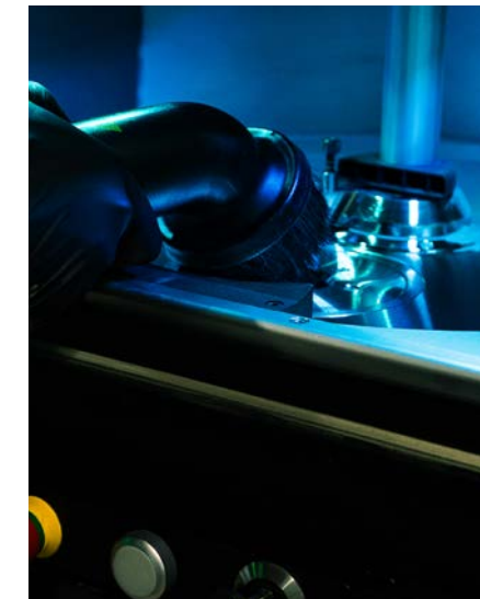
Überschüssiges Material wird zur Aufbereitung abgesaugt
